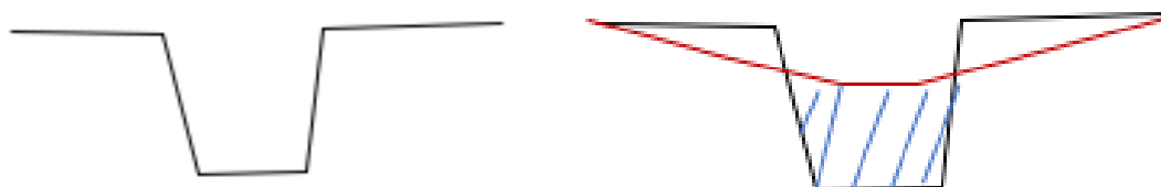
Schéma de comblement partiel des fossés pour maintenir des micro-habitats plus longtemps submergés
