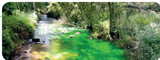
Mesure du temps de transfert entre la station d'alerte et la prise d'eau par injection de fluorescéine
